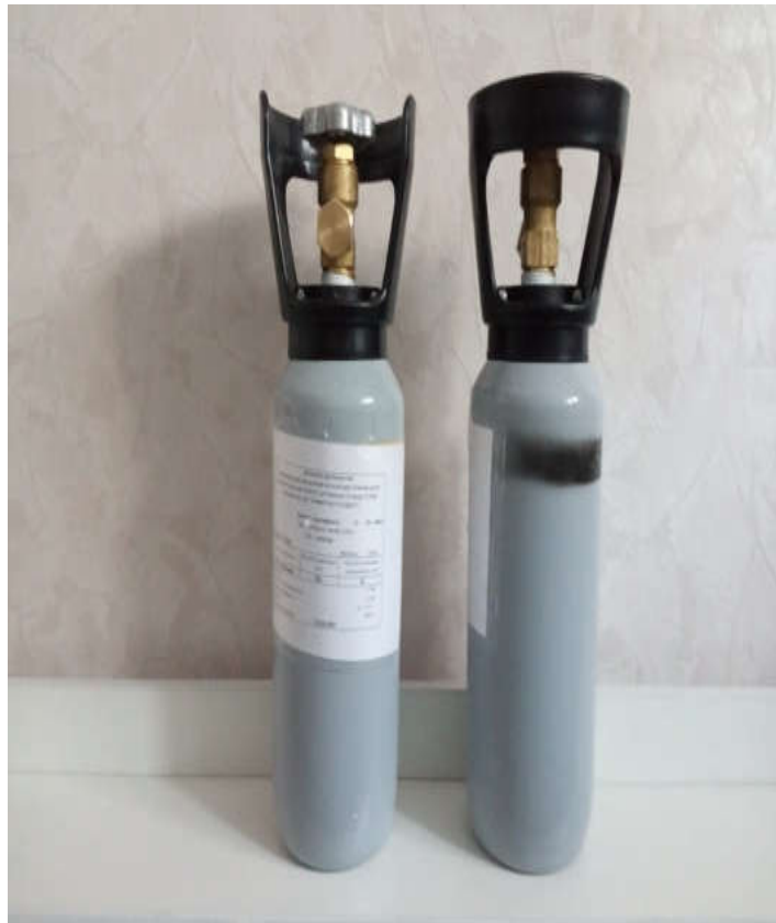
Рис. 6 - Балони високого тиску з сертифікованими повірочними газовими сумішами \text{CO}_2 і \text{NH}_3 для калібрування АПСЕ-М
